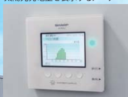
太陽光発電量を表示するメーター
