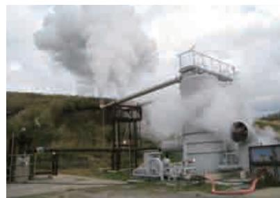
地熱を利用した噴気実験で、蒸気が噴出する様子
